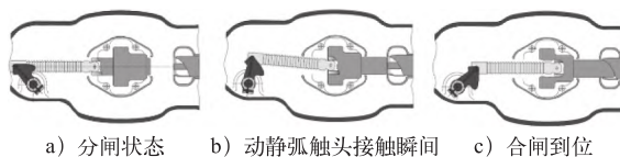
图3 隔离开关触头的三种关键状态
