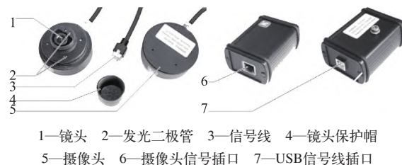
图5 照明、镜头及摄像系统构成
