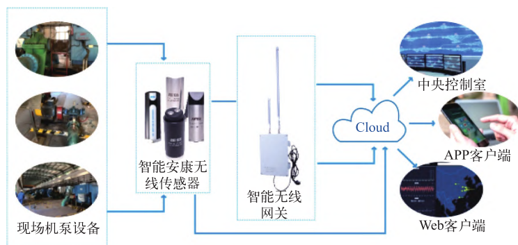
图1 系统软硬件架构图
