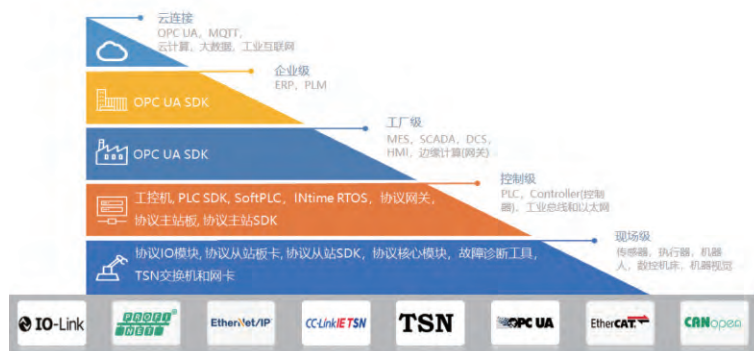
图4 工业自动化金字塔架构图
