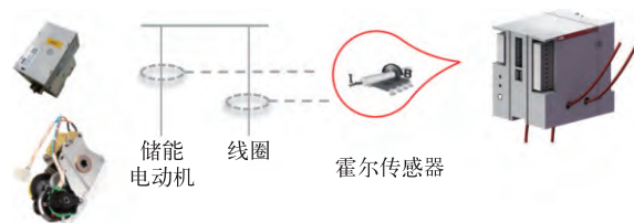
图6 通过霍尔传感器感应线圈电流，控制回路无须增加触点
