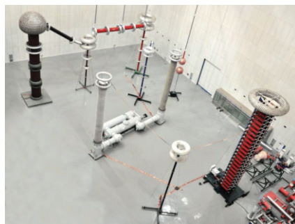
图7 1 100 kV断路器绝缘型式试验样机布置
