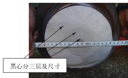
图3 断裂瓷支柱绝缘子断口形貌
