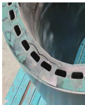
图1 端面树脂开裂
