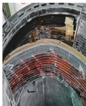
图3 短路点位于第二层导线
