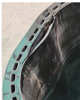
图2 内壁树脂开裂
