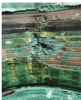
图4 导线熔断情况
