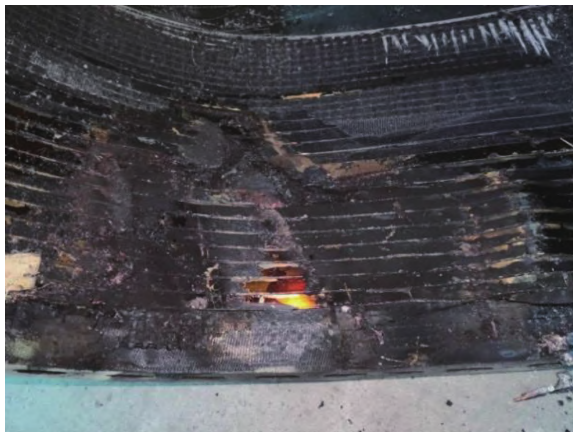
图2 导线表面绝缘漆碳化
