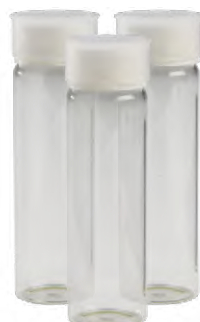
药企常用的进样瓶，从结构上可分成三个部分：瓶盖、瓶垫和瓶身。
