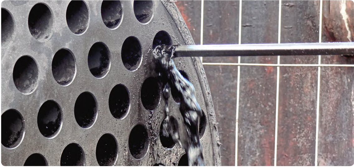
在机械式清洁工艺种，可以省去化学准备，从而降低排放风险和能源成本
