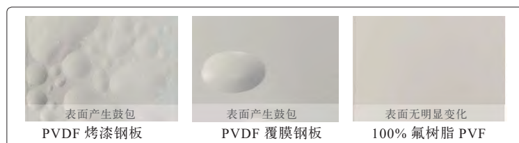
图 1 将 \text{H}_2\text{O}_2 (30%) 溶液滴在样品表面 500 h 后产生的变化
