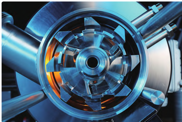
FrymaKoruma Dinex 高剪切乳化机的内置转子定子均质器
