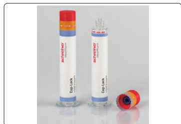
图3 带有完整穿孔线的标签延伸到适配器。当打开注射器的盖子时,会产生不可还原的破坏。适配器与护帽互锁,不会产生额外的废物
