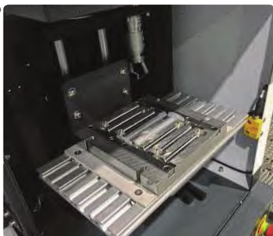
安全、精确地打印标记：个性化定制的支架优化了标记打印时间
