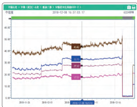
图12 1 # 催化烟机运行336天轴系振动趋势(2018年12月检修)
