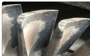
图5 1#催化烟机运行366天 (2021年6月检修)
