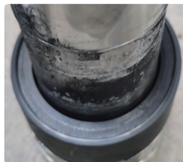
图 1 一级动环磨损状态
