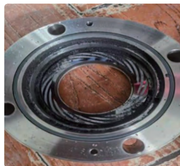
图 2 磨损后抑制密封腔内部状态
