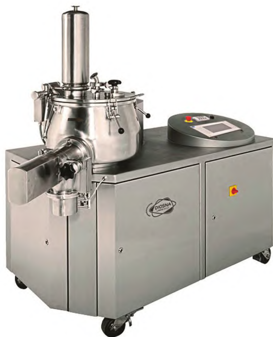
Diosna 的混合制粒机 HSG P60 适用于中试和生产应用
