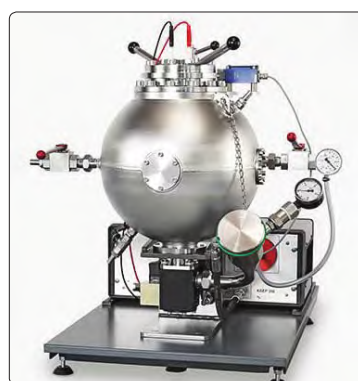
由 Richard Siwek 先生发明、TÜV SÜD 瑞士公司制造的 201 球测试设备
