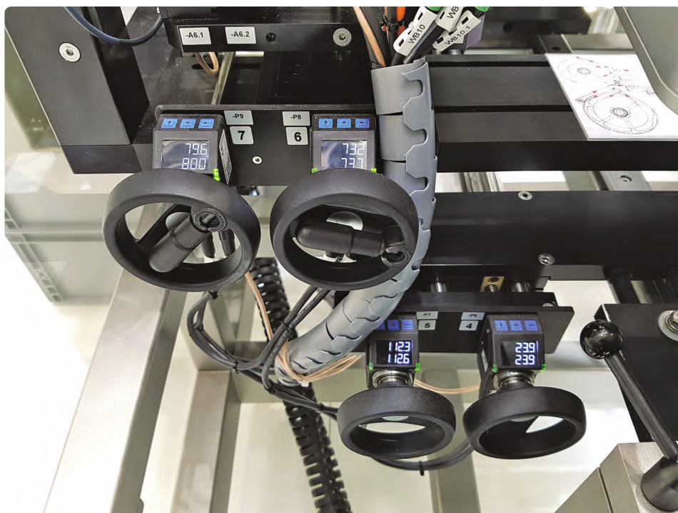
在药品生产中通过 SIKO 位置指示器在一台“追溯”设备上规格转换
