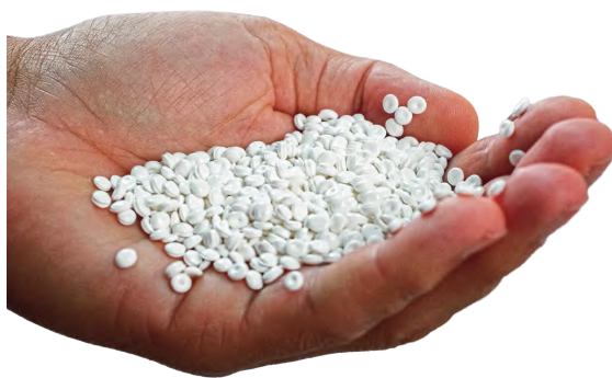
Südpack 使用来自回收油的聚酰胺颗粒来生产多层食品包装薄膜
