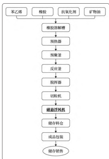
图1 聚苯乙烯装置风送系统流程图
