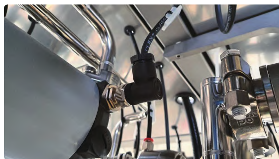
由于连接器更小，现在 GTec 也可以使用更小的阀门
