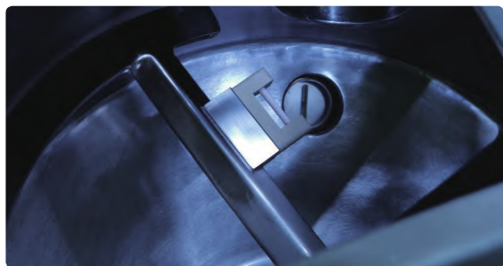
Tempris 传感器可固定安装在混合组件的叶片上。该系统是由欧洲和美国的制药公司与大学合作开发的, 传感器既可用于实验室, 也可用于符合 cGMP 标准的中试和生产设备
