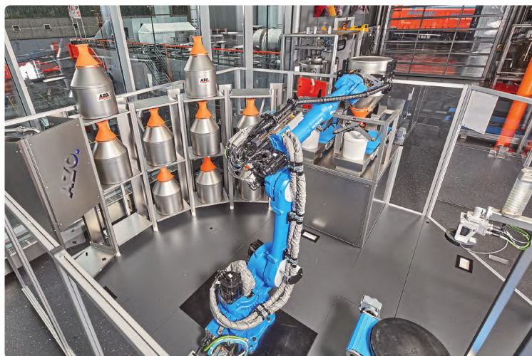
会跳舞的机器人？不完全是：RoLog 在人工智能的支持下，将小部件组装起来
