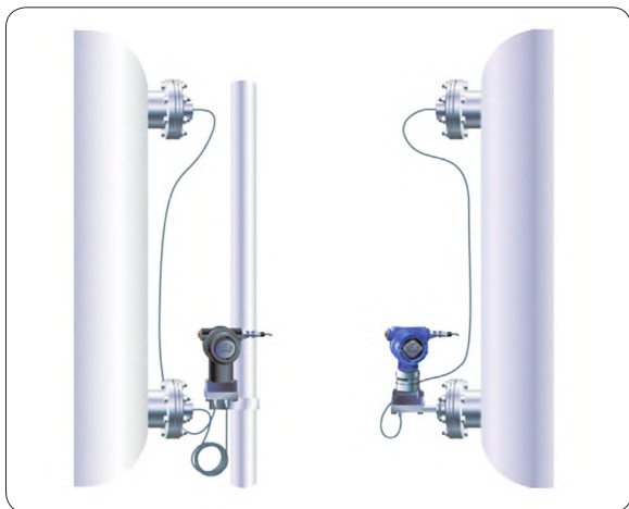
图3 双法兰差压液位变送器测量液位示意图
