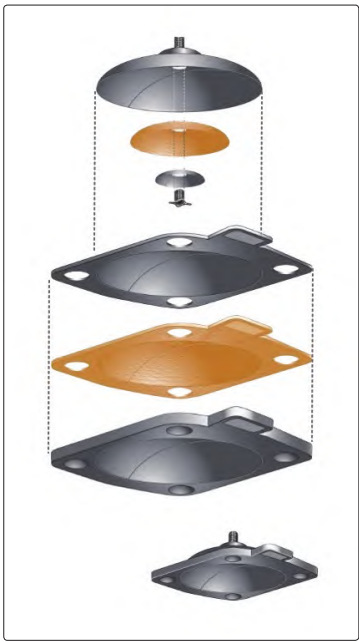
图5 新型 ER 弹性膜片的复合型编织层结构
