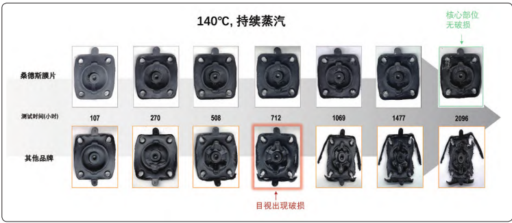
图4 在140℃连续蒸汽下膜片的测试效果
