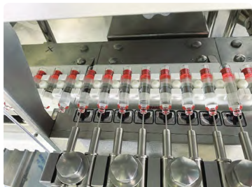
灌装分三步进行，并通过激光检测系统实现理想的灌装液位
