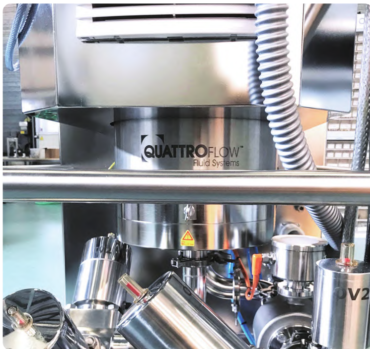
Quattroflow™ 四柱塞隔膜泵可以柔和地处理脆性 / 刚性树脂，能在树脂填充工艺中发挥重要作用
