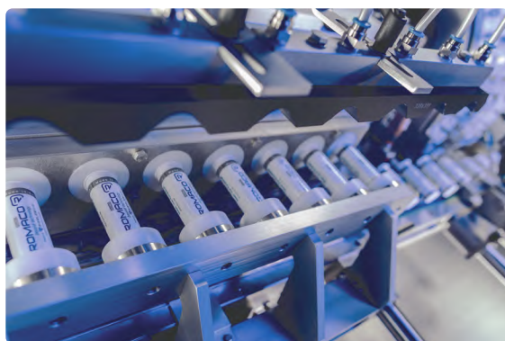
Romaco Siebler STF 120 泡腾片硬管包装机可对泡腾片进行精确的分装
