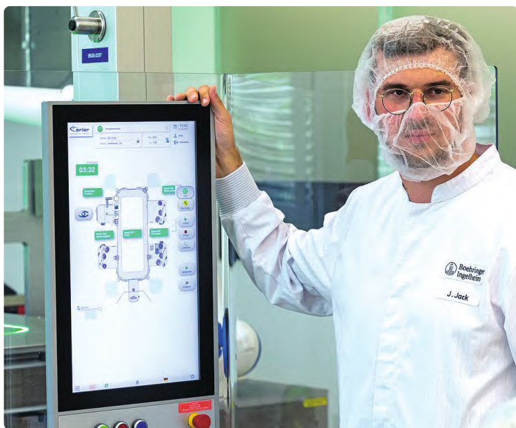
HMI 展示了机器的各个站点
