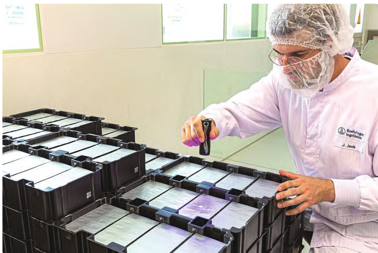
空白泡罩储存在此类托盘中，直到重新打印
