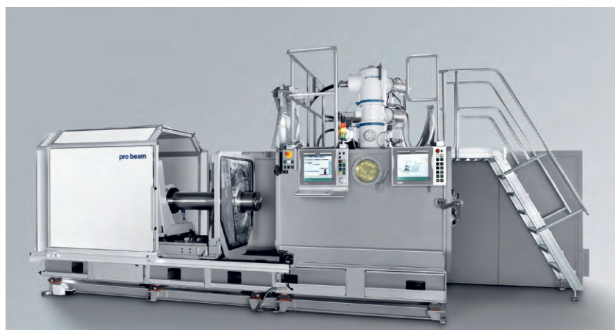
图 2 Pro-beam 公司研发生产的 PK 20 型微孔加工机床。它可用于钛合金的微孔加工，被加工材料的最大厚度可达 6\mu\text{m}
