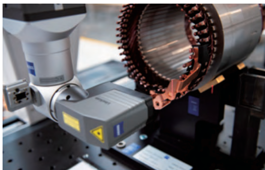
图 ZEISS LineScan 对整个绕组头进行数字化，以便比较点云与 CAD 模型
