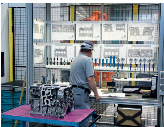
图5 将手动测量和检测站集成到自动化工艺流程中
