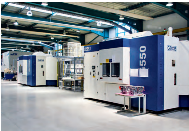
图6 灵活的生产单元由格劳博五轴联动通用加工中心 G550 组成
