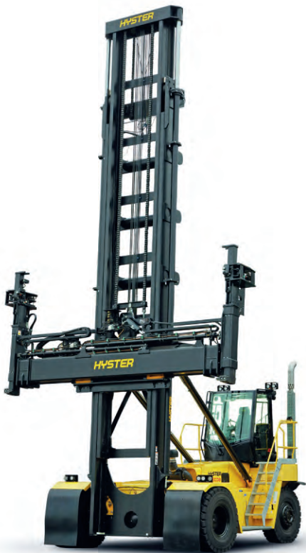
图 4 Hyster 公司设计制造的空箱堆垛机可以堆叠八层集装箱
