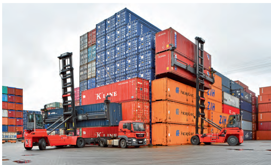
图 2 Kalmar 公司的 DCG 100 型空箱堆垛机的最大提升重量为 10 t、最大提升高度为 18.5 m
