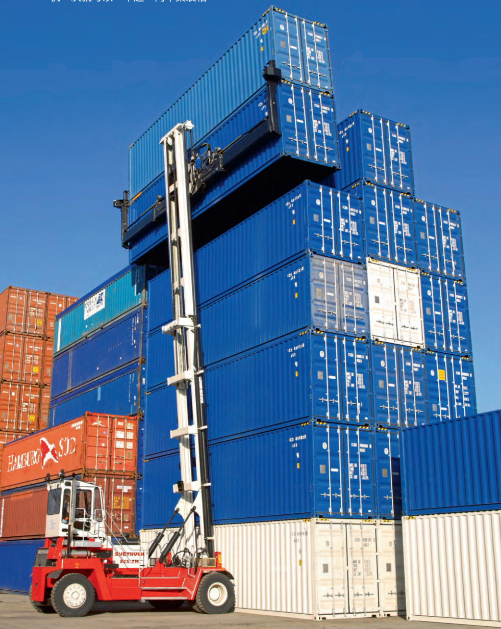
图1 目标远大双倍的提升能力： Svetruck 公司研发生产的空箱堆垛机一次就可以“举起”两个集装箱
