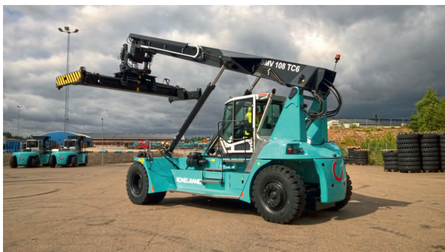
图 3 与使用变矩变速器的空箱堆垛机相比，新一代 HTV 正面吊最多可节约 40% 的燃油
