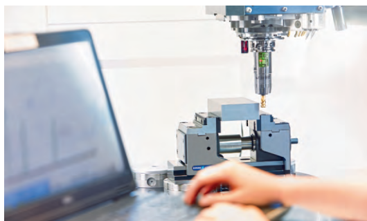
图 5 Itendo 公司研发生产的智能刀夹可以实现实时的刀具监控。尽管刀夹中配置了传感器，但刀夹的几何参数和性能数据都保持不变
