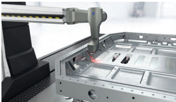
图 3 用配备蔡司鹰眼装置的光学线激光三角测量方案测量电池托盘
