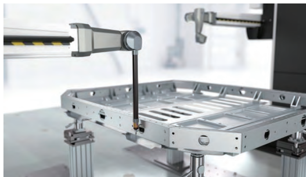
图2 使用蔡司悬臂式三坐标测量机对电池托盘进行接触式测量
