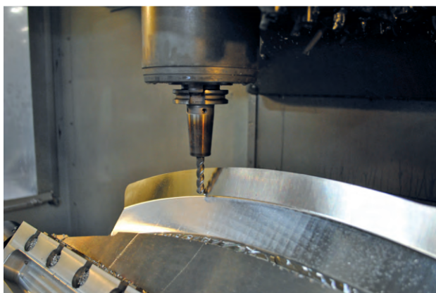
图 Skills 公司的金属材料去除率 (MRR) 提高 30%，废品率从 7% 下降到 3%
