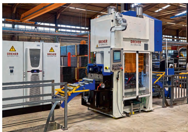
图 1 压力机、辊式带料输送机 and 新的电气控制柜
