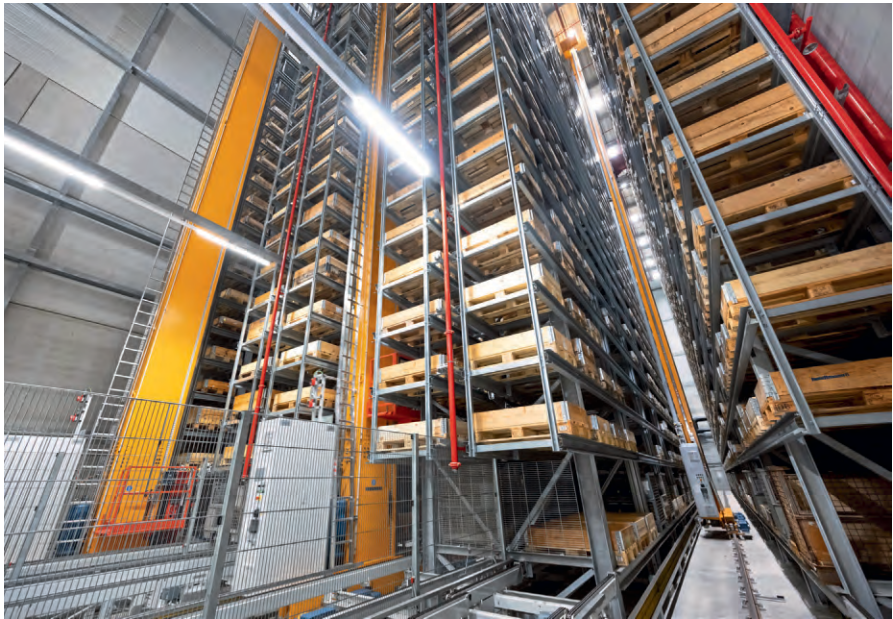
图 2 DEMATIC 公司提供的物流中心解决方案中包括了一个高架立体仓库和三台自动存取堆垛机
