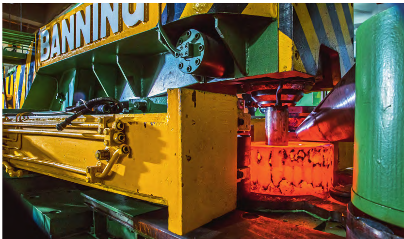
图 1 在 IBF 的 Banning H100/V80 径向和轴向环轧机上轧制热钢环
