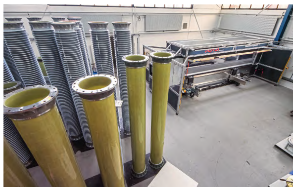
图3 去毛刺站可以加工各种尺寸和重量的绝缘子
