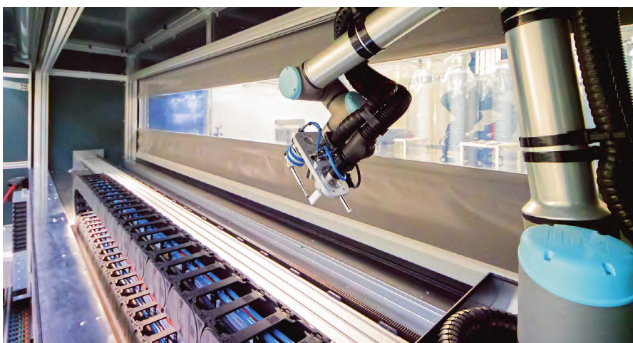
图 1 工业机器人引导着去除绝缘子上毛刺的工具，此时它处于静止位置
