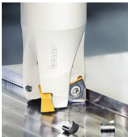
图2 夹持双面凸三角铣刀片的 HELIDO 600 铣刀
