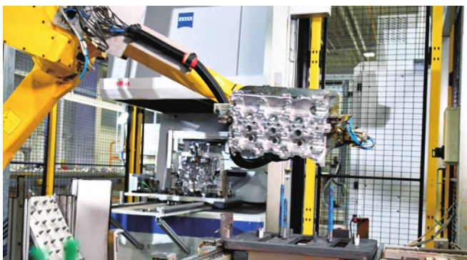
图 2 蔡司在线测量工作站完全实现自动化操作：机械臂抓取位于进料口的气缸盖罩，将其托举至鼓风机处，吹去残留的金属碎片，然后将盖罩夹紧在装载台上
