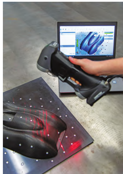
图 3 Bräutigam 公司工作人员使用 HandySCAN 3D 进行测量
