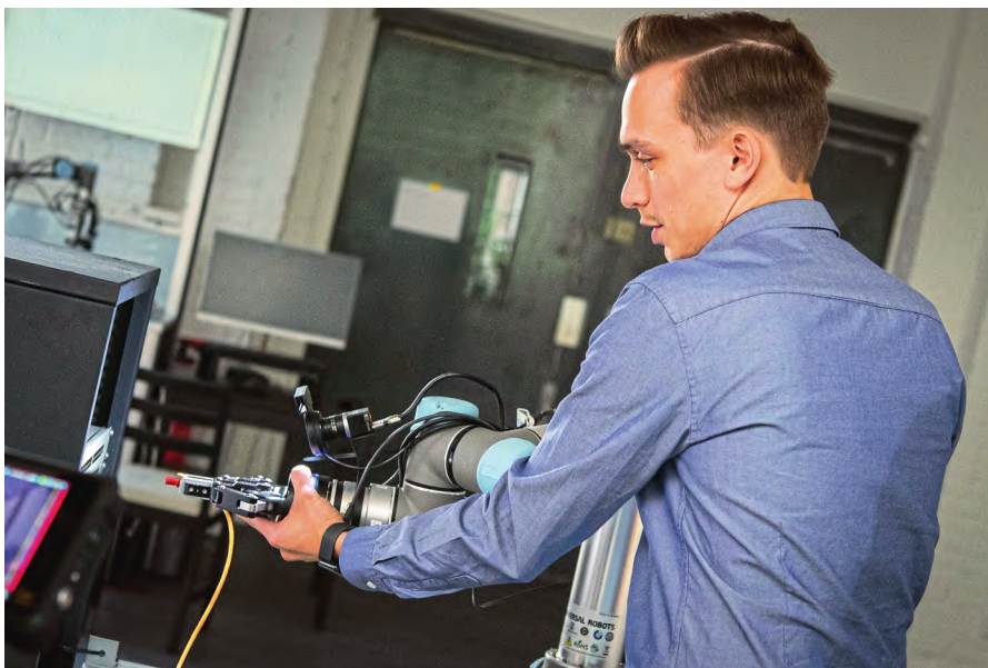
图 3 Mirai 系统控制的机器人通常能够在出现的多个变型物体中找出目标物体。AI 人工智能控制系统能够从摄像头拍摄的图像和显示的位置变化中导出控制机器人的运动方式，使机器人可在不熟悉的环境中正常工作
