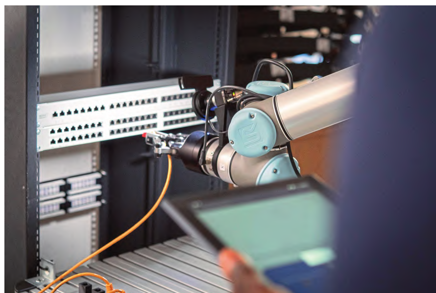
图 2 能够在不熟悉的环境中工作以及处理变型产品的机器人，可以将手动工作站升级到自动化的工作站，例如在装配工作领域中
