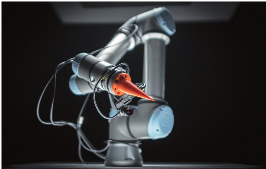
图 4 配备了 Micropsi Industries 公司研发生产的 Mirai 人工智能控制器的 UR 协作机器人
