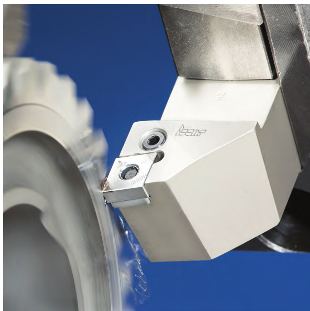
图3 用于淬硬工件车削的CBN牌号IB20H刀片
