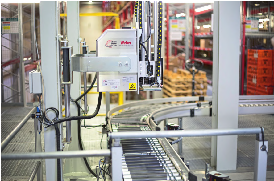
图 3 贴标头旋转臂伸出来，直到它探测到包装物的上表面为止，全过程无接触的将标签吹贴到位
