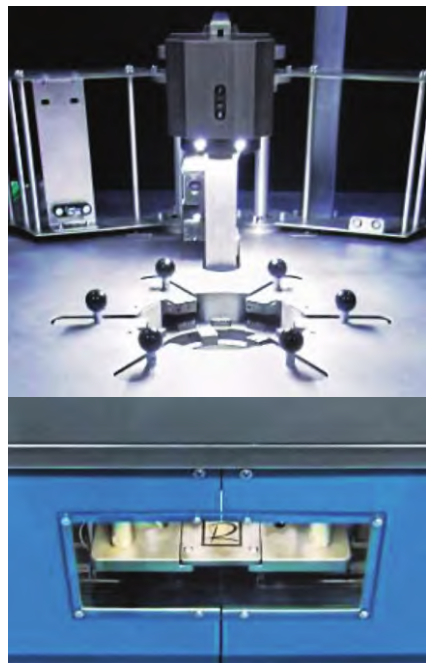
图 2 SMC 的电轴在 Riedmayer Engineering & Maschinenbau 的装配站定位线圈和外壳，并检查成品工件
