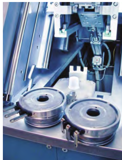
图 4 借助 SMC 的电驱动器和 JXCP 控制器，半自动化生产站可以安全、精确地弯折电动机的触点
