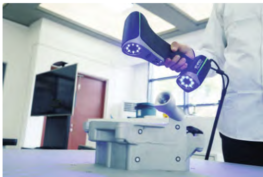
工作人员使用 KSCAN-Magic 复合式 3D 扫描仪进行测量
