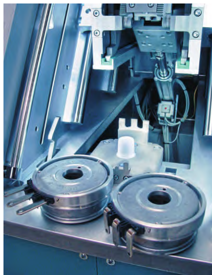
图3 Riedmayer Engineering & Maschinenbau 的两个装配和折弯站设计精巧，可实现涡轮增压器电驱动生产的自动化
