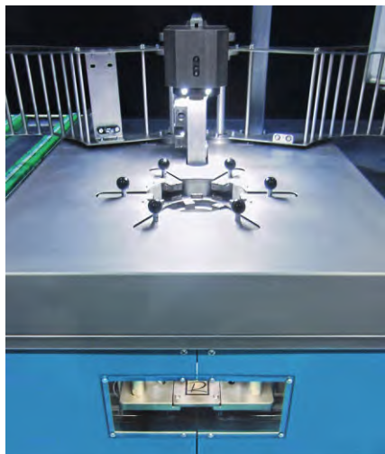
图2 SMC 的电轴在 Riedmayer Engineering & Maschinenbau 的装配站定位线圈和外壳，并检查成品工件
